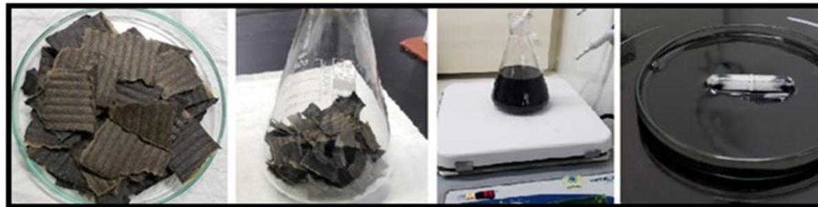
Figura N° 2.: Proceso de extracción del material retenido en el elemento filtrante
